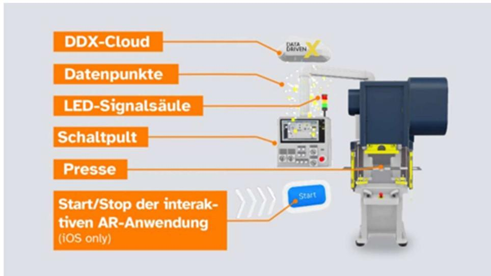
Um die Funktion der Maschine darzustellen, haben wir anschließend das Modell animiert. Das heißt, die Presse läuft und die IoT-Daten der Maschine „strömen“ in die Cloud. Um diese Animation effektiv und zum richtigen Zeitpunkt in das Verkaufsgespräch einfließen zu lassen, haben wir eine Start-Stopp-Funktion eingebaut. Jedes Starten und Stoppen der Presse führt zu einem Datensatz, ebenso jeder Pressvorgang. All diese Daten strömen von der Steuerkonsole aus nach oben in die DDX-Cloud.
